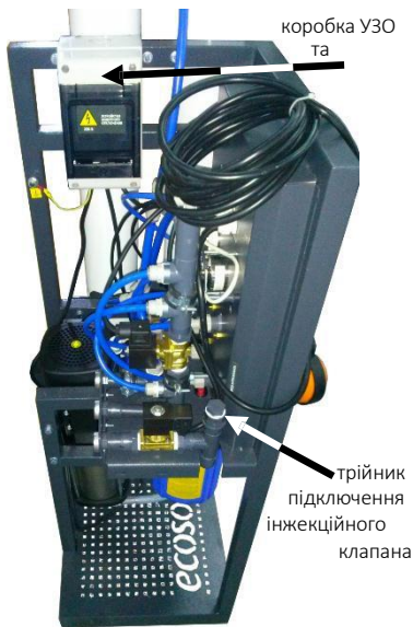
Рис. 3 Точки підключення насоса-дозатора до пристрою зворотного осмосу MO6500
